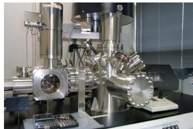
X線光電子分光装置(XPS)：試料にX線を照射したときに放出される光電子を検出することで、試料にどんな原子や化学結合があるのかを分析できる。
