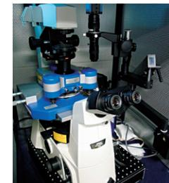
原子間力顕微鏡：物体の凹凸を0.1ナノメートル単位で計測が可能。
